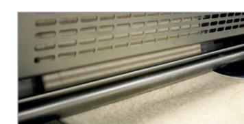
5. Estação de redução: o tapete de massa é reduzida à sua espessura final ao passar pelos rolos.
