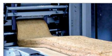
2. Quick Reductor (Estação multirolos): a primeira redução da espessura do tapete de massa é feita por um Quick Reductor. Devido aos nossos rolos antiaderentes exclusivos, somos capazes de processar tipos de massa com alta porcentagem de água.
