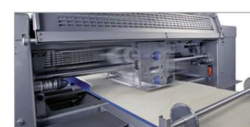
4. Rolo transversal: para compensar a redução lateral das estações de redução e para ajustar a espessura do tapete de massa. O tapete de massa diminuirá em espessura e aumentará em largura.
