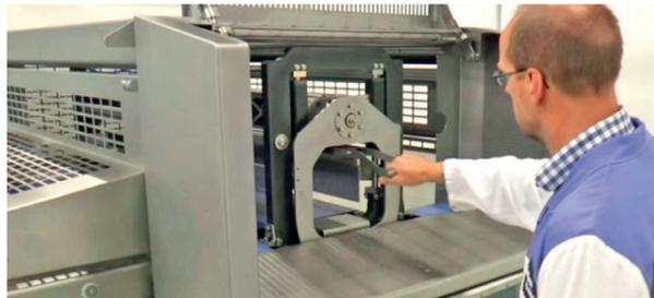
A operação eficiente e sem erros da troca de ferramentas são realizadas aplicando-se o Unique Fit Tooling. Devido ao ferramental leve e mais compacto, o manuseio e desmontagem das ferramentas é o mais fácil possível e pode ser feito por uma pessoa. Nenhum outro dispositivo é necessário para ajudar o operador a trocar as ferramentas.
