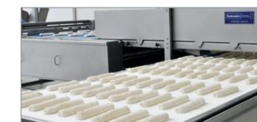
Nossos sistemas de carregamento de bandejas são capazes de carregar com precisão os produtos nas assadeiras, tábuas de descascar (peel boards), formas ou esteiras de transporte. Desenvolvemos vários sistemas para fornecer uma solução para cada situação específica.
